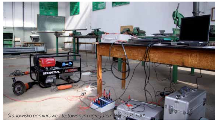
Stanowisko pomiarowe z testowanym agregatem Honda EC 6000
