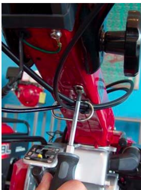
(f) Wkręć śrubkę mocującą osłonę zabezpieczającą przed splątaniem i skręceniem przewodów.
