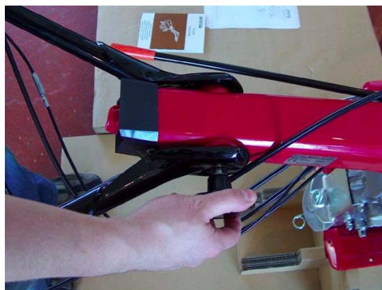
(e) Dopasuj otwory w ramie rączki do otworów w kolumnie kierownicy i wkręć pokrętko mocujące. Zębate wykończenie otworów pozwala na dowolną regulację ustawienia wysokości rączki kierownicy.
