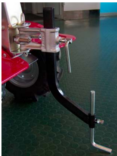
(d) Zainstaluj skręcony zespół tylnej podpórki w uchwycie zaczepu i zablokuj sworzniem i zawleczką.
