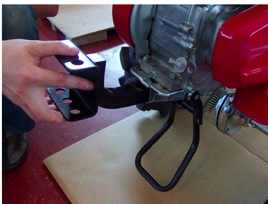
(b) Wsuń zaczep w miejsce mocowania
