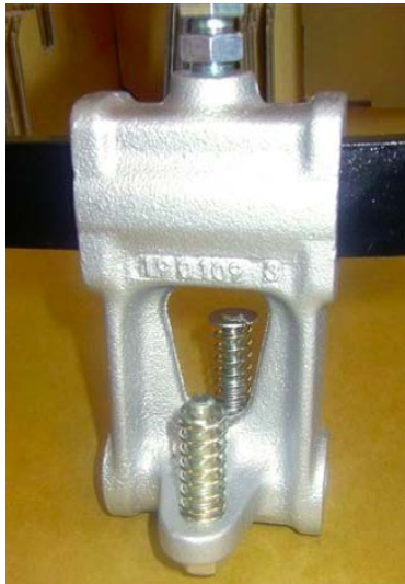
(b) Zamontuj podkładki stopujące, sprężynki na śrubach zaczepu.
