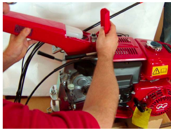
(a) Osadź kolumnę kierownicy na wałku kolumny.
