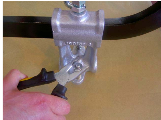
(c) Zaciśnij podkładki stopujące
