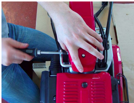
(d) Osłonę przykręć z dwóch stron śrubkami.
