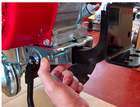
(c) Zabezpiecz zaczep mocując dwie śruby i nakrętki w otworach mocujących.
