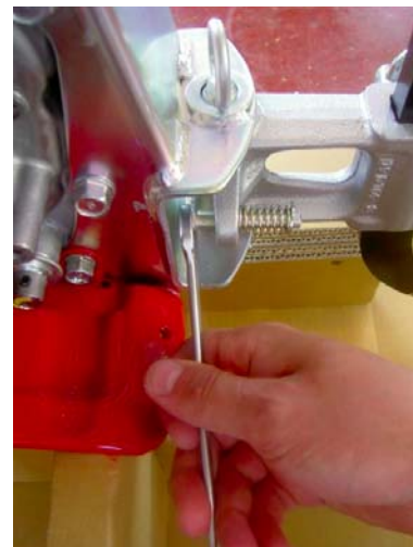
(c) Zaciśnij podkładki stopujące
