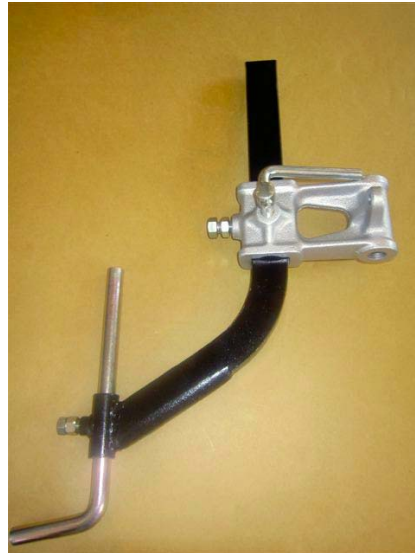
(a) Zmontuj tylną podpórkę i łyżwę w sposób pokazany na rysunku.
