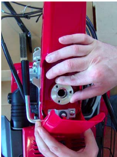
(b) Wkręć ręką nakrętkę mocującą kolumnę kierownicy.
