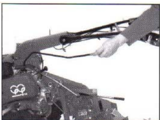
3) Dźwignię zmiany biegów ciągnika jednoosiowego przełącz na luz.
