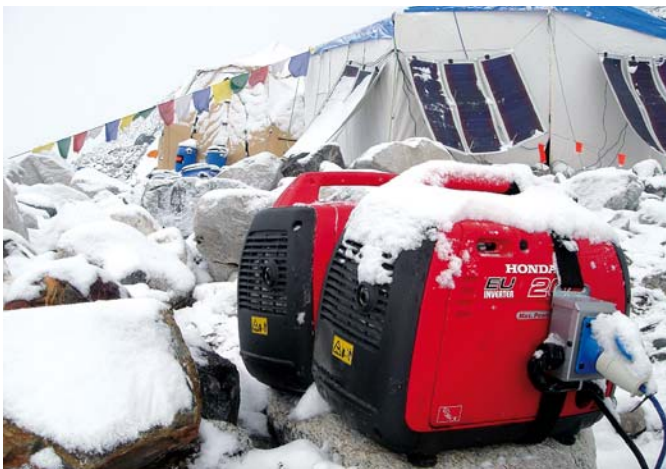
Połączone szeregowo dwa agregaty Honda EU20iS
