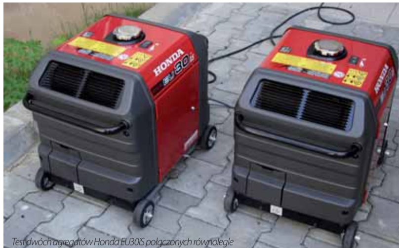
Test dwóch agregatów Honda EU30iS połączonych równoległe
