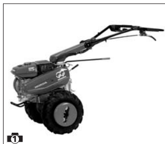
Ciągnik F510 z kołami wyposażonymi w obciążniki kół 20 kg
